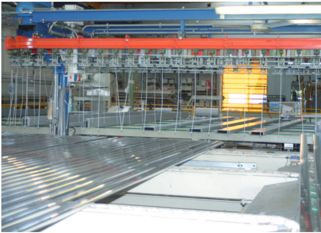
8 - Un esempio dei ganci agganciati al convogliatore, cui vengono appesi i profili d'alluminio da verniciare
